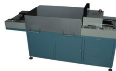
Рис. 15. Конвейерная ИК-печь «Радуга-3» с постоянной конвекцией
