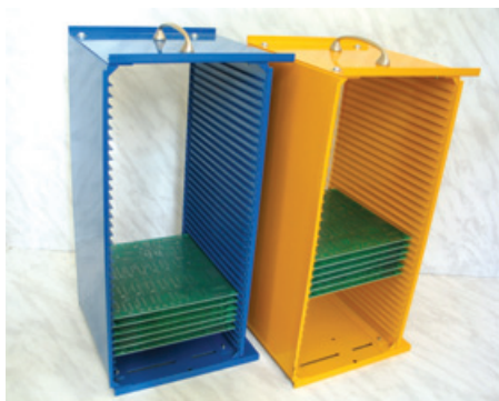
Рис. 18. Технологическая тара «S.M.D.-Трасса-43051»
