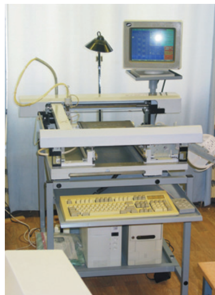
Рис. 11. Установка поверхностного монтажа ЭВ-8317-2М
