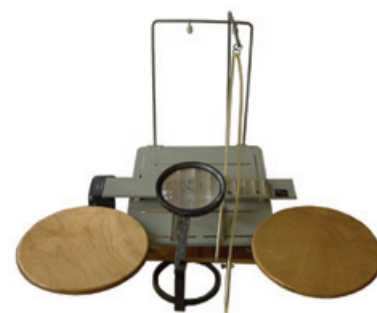
Рис. 9. Оснастка для ручной установки поверхностно монтируемых элементов на ПП
